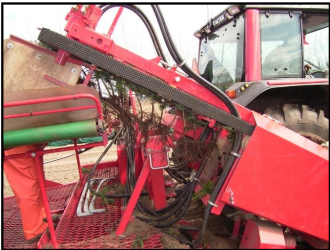
Effektivt rystesystem – rene planter Efficient shaking system – clean plants Effektives Rüttelsystem – reine Pflanzen
